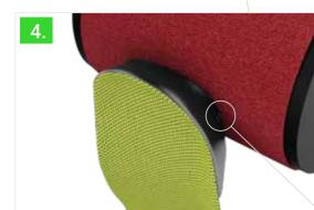
Lija el material sobrante para estabilizar en forma neutra, o realiza una cuña empleando las marcas realizadas en el lateral. Lija posteriormente los bordes de la talonera.
