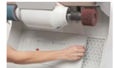
Schiebeklappe um Absaugbereich festzulegen.
