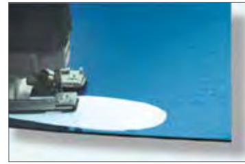
Gewünschte Form aussägen, anschließend entgraten.
